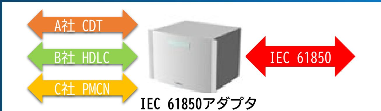
最小限の開発で各社の従来通信（CDT, HDLC, PMCN）に対応します
